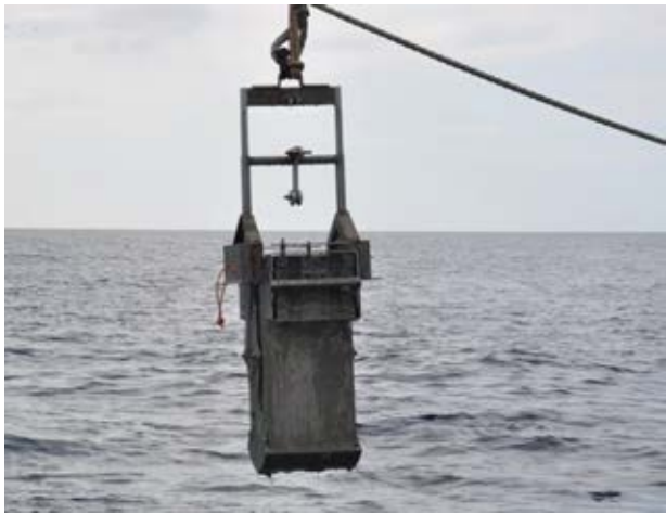
รูปที่ 3.2 อุปกรณ์การเก็บตัวอย่างดินตะกอนแบบ Box corer
