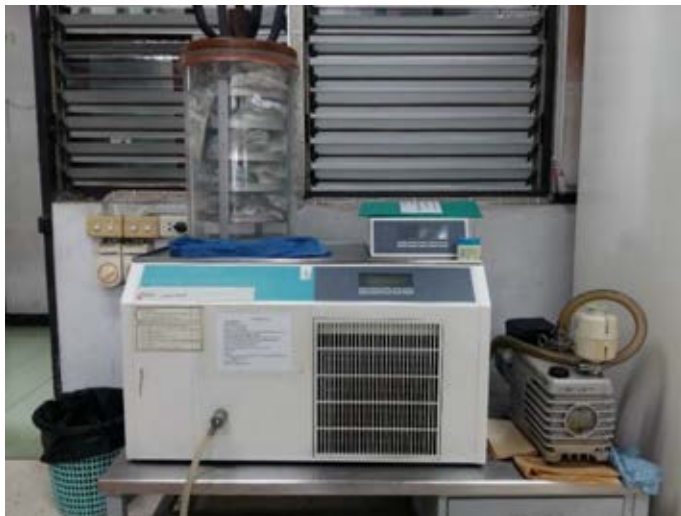
รูปที่ 3.4 เครื่อง Freeze drier ยี่ห้อ Heto รุ่น LyoPro6000 และ การ freeze-dry ตัวอย่าง
