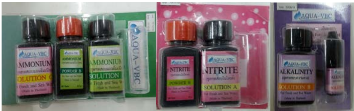
รูปที่ 8 ชุดตรวจวัดคุณภาพน้ำ (test kit) AQUA-VBC ของคณะสัตวแพทยศาสตร์ จุฬาลงกรณ์มหาวิทยาลัย
