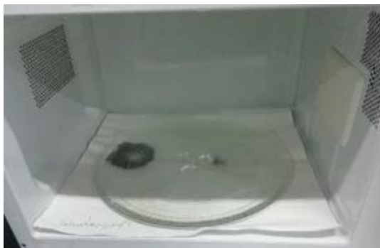
รูปที่ 5. ภาพแสดงจุดบริเวณ Hot spot ของไมโครเวฟที่ใช้ในการทดลอง
