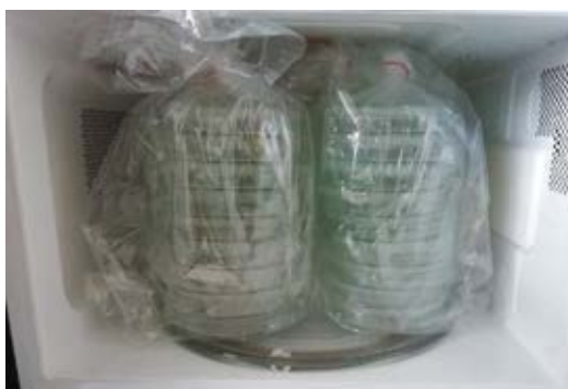
รูปที่ 2. ถุงพลาสติกที่มีจานแก้วบรรจุอยู่ 9 ใบ ต่อ 1 ถุง ทั้งหมด 3 ถุงในเครื่องไมโครเวฟ
