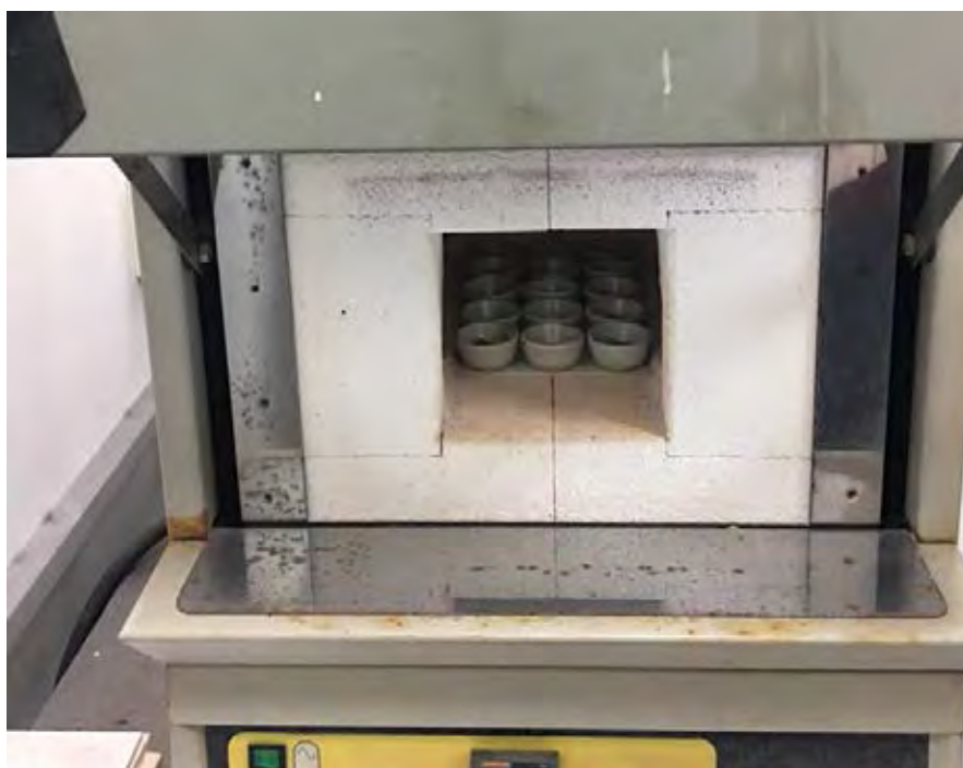
รูปที่ 2.3 การนำตัวอย่างเข้าไปเผาในเตาเผาอุณหภูมิสูง
