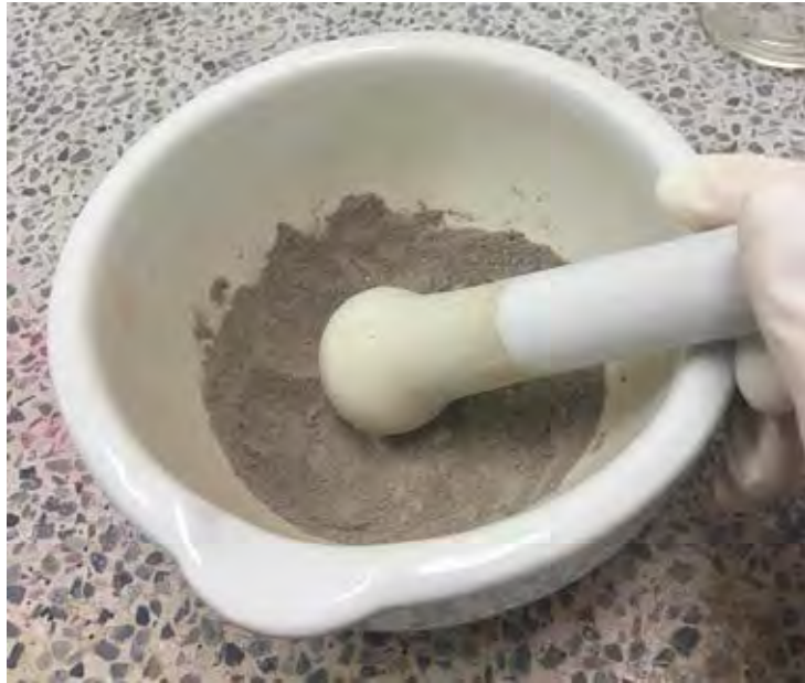
รูปที่ 2.4 การบดตัวอย่างสำหรับอัดเพื่อทำ XRF โดยใช้ครก
