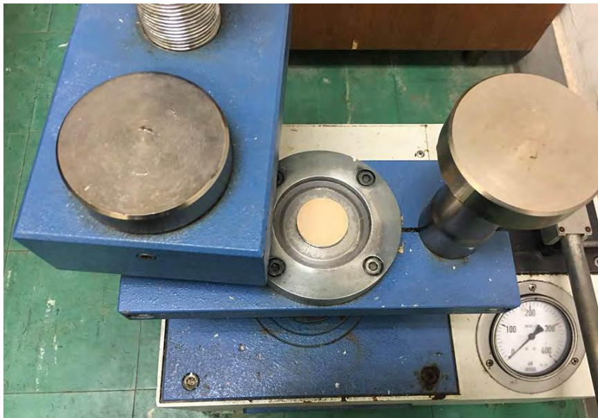
รูปที่ 2.5 การอัดตัวอย่างเพื่อทำการวิเคราะห์ด้วยเครื่อง XRF
