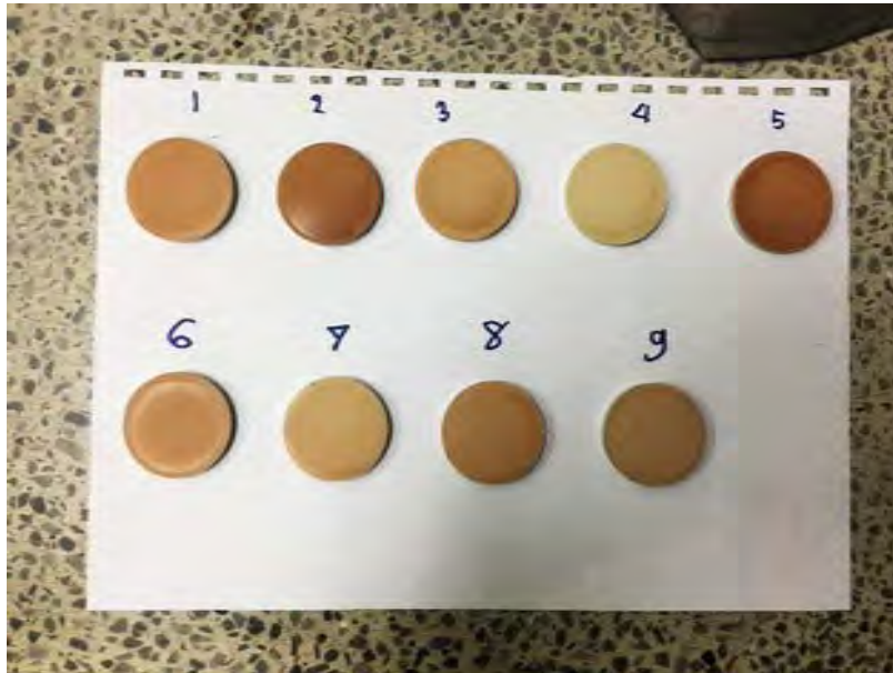
รูปที่ 2.6 ตัวอย่างที่อัดเสร็จเรียบร้อยแล้วพร้อมวิเคราะห์ด้วยเครื่อง XRF
