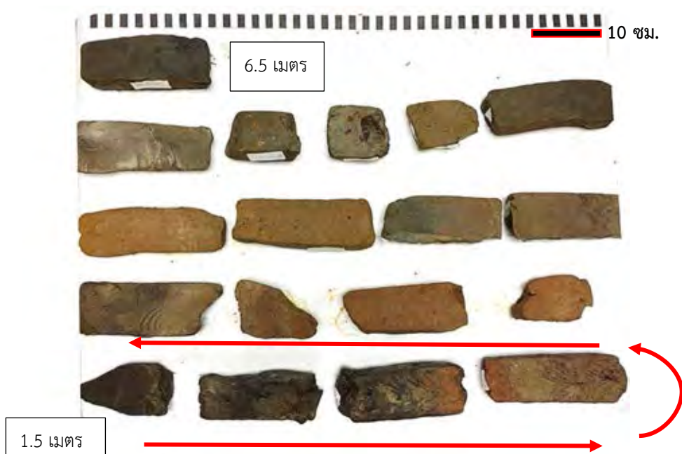
รูปที่ 2.1 ตัวอย่างการเรียงลำดับตะกอนตามลำดับความลึกของหลุมเจาะที่ 2 โดยเรียงตามทิศทางลูกศร
