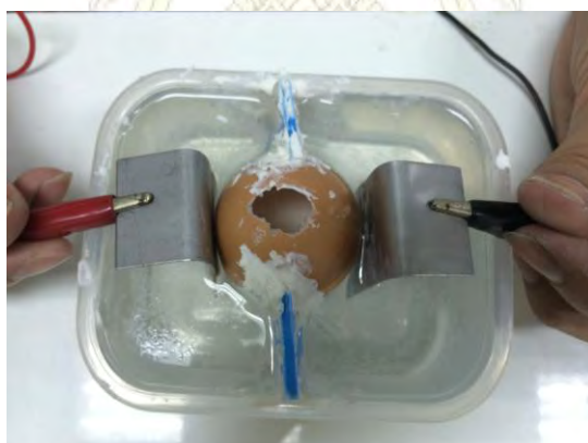
รูปที่ 3.13 การวางตำแหน่งของขั้วไฟฟ้าโดยให้ขั้วไฟฟ้าชนิดขบเปลือกไข่
