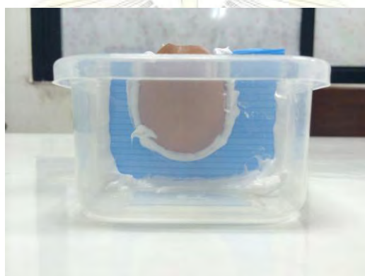
รูปที่ 3.9 ภาพด้านหน้าของการยาแนวซิลิโคนของเปลือกไข่กับกล่องพลาสติก
