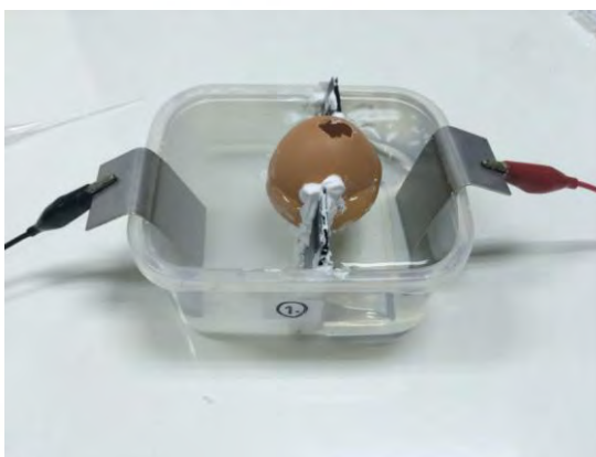
รูปที่ 3.12 การวางตำแหน่งของขั้วไฟฟ้าโดยให้ขั้วไฟฟ้าชนิดขบกระบะแบบจำลอง
