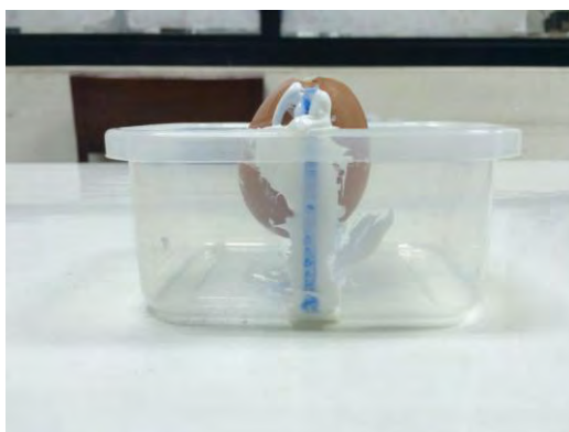
รูปที่ 3.8 ภาพด้านข้างของการยาแนวซิลิโคนด้านข้างของเปลือกไข่กับกล่องพลาสติก
