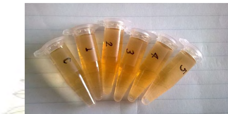
รูปที่ 4.7 สีของอนุภาคนาโนของซีลีเนียมที่สังเคราะห์ได้เมื่อปรับเปลี่ยน ปริมาตรของพุลลูแลน 5% จาก 0-800 \mu\text{L} โดยใช้แอล-ซิสเทอีน 2.5 mM และใช้โซเดียมซีลีไนต์ 2 mM C = 0 \mu\text{L} , 1 = 100 \mu\text{L} , 2 = 250 \mu\text{L} , 3 = 400 \mu\text{L} , 4 = 650 \mu\text{L} และ 5 = 800 \mu\text{L}
