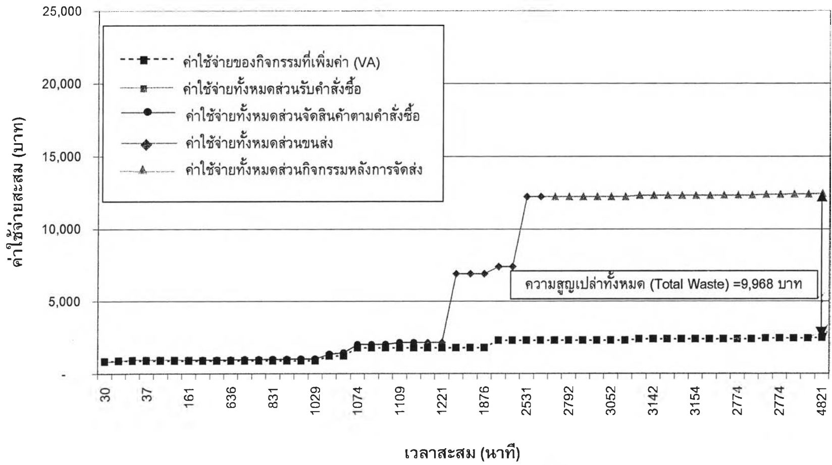
รูปที่ ค.14 Cost-Time Profile ของการขนส่งและการจัดส่งผลิตภัณฑ์น้ำมันหล่อลื่นด้วยรถบรรทุก 6 ล้อ ไปยังพื้นที่ความต้องการที่ 1 ในกรณีที่ไม้อัดพิกที่จุดพักรถ
