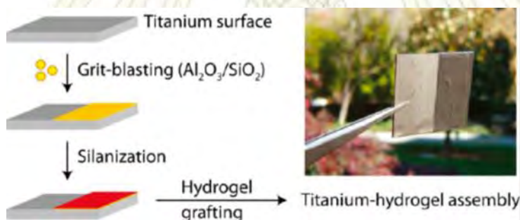
รูปที่ 1.2 ขั้นตอนการดัดแปรพื้นผิวของไททาเนียมด้วยการกราฟต์ไฮโดรเจลบนพื้นผิว [5]
