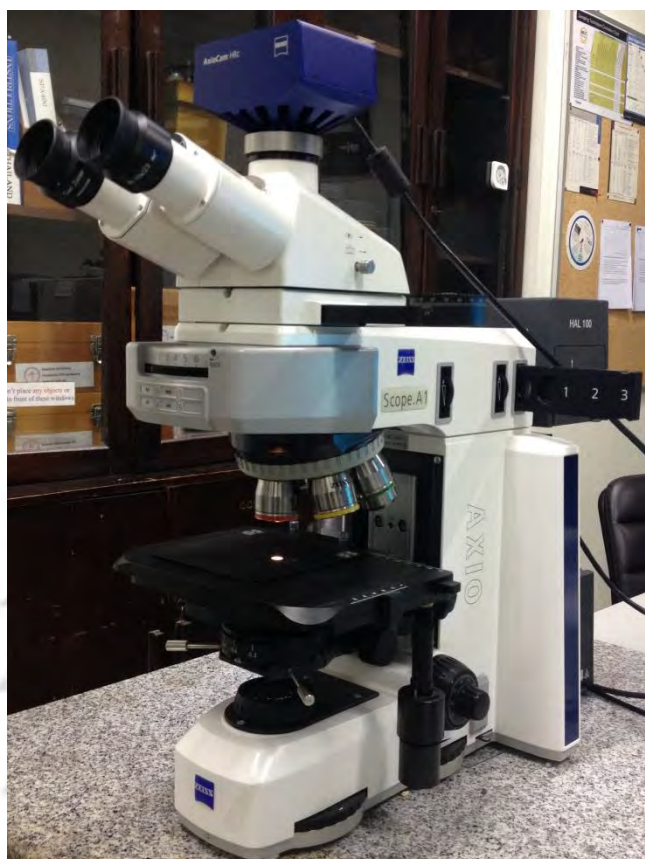
รูปที่ 3.3 กล้องจุลทรรศน์ ยี่ห้อ Carl Zeiss รุ่น Axio Scope.A1 ใช้ในการถ่ายภาพวัตถุ
