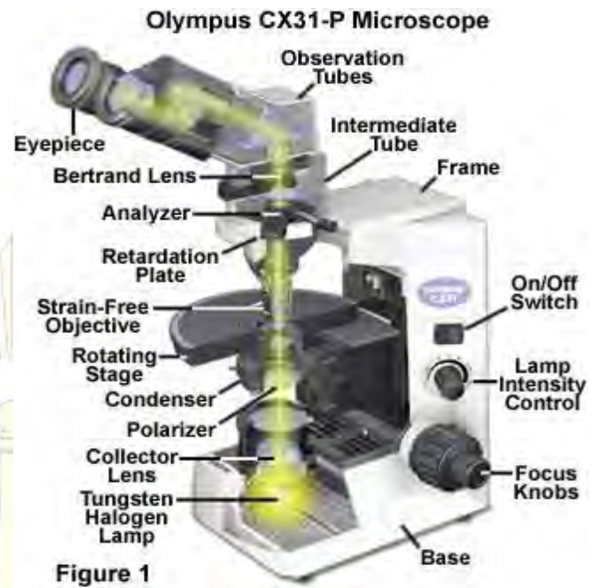
รูปที่ 2.2 หลักการทำงานของกล้องจุลทรรศน์แสง ( Optical microscopes) แบบ Polarizing Microscope (ที่มา: http:// www.olympusmicro.com )
