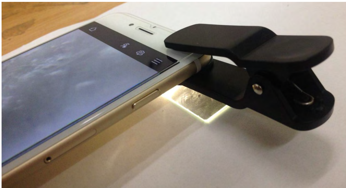
รูปที่ 3.12 การใช้งานอุปกรณ์เสริมกล้องจุลทรรศน์โหมดสะท้อน (Reflection)
