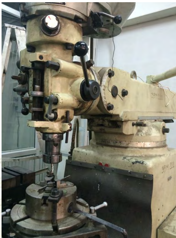
รูปที่ 3.1 เครื่องกัด (Milling Machine) ใช้ในการกัดอะคลิลิคให้มีพื้นผิวสม่ำเสมอ เรียบเนียน
