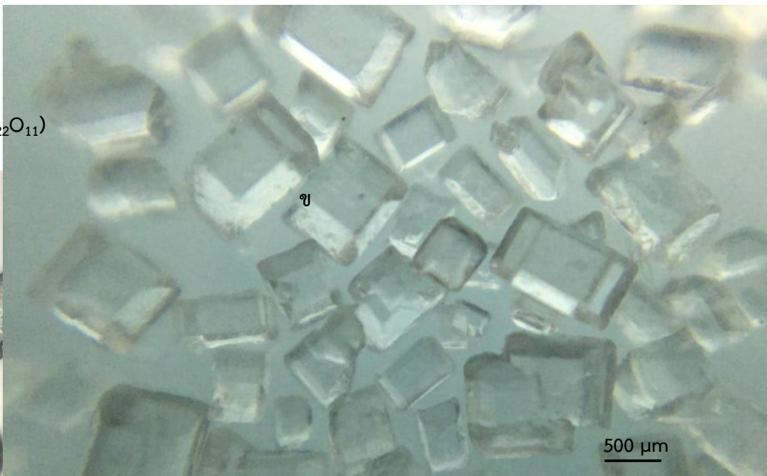
รูปที่ 4.7 ก ภาพถ่ายผลึกน้ำตาลด้วยกล้องจุลทรรศน์ในห้องปฏิบัติการโหมดสะท้อน (Reflection) ยี่ห้อ Carl Zeiss รุ่น Axio Scope.A1 กำลังขยาย 50x ข ภาพถ่ายผลึกน้ำตาลด้วยกล้องจุลทรรศน์สมาร์ทโฟนโหมดสะท้อน (Reflection) ยี่ห้อ Apple รุ่น iPhone 6 ด้วย Plano convex Lens ที่มีขนาดเส้นผ่าศูนย์กลาง 6.0 มิลลิเมตร กำลังขยาย 50x
