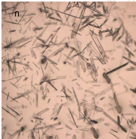
รูปที่ 4.17 ก ภาพถ่ายผลึกเกลือซิลเวอร์อะซีเตตด้วยกล้องจุลทรรศน์ในห้องปฏิบัติการโหมดส่องผ่าน (Transmission) ยี่ห้อ Carl Zeiss รุ่น Axio Scope.A1 กำลังขยาย 50x ข ภาพถ่ายผลึกเกลือซิลเวอร์อะซีเตตด้วยกล้องจุลทรรศน์สมาร์ตโฟนโหมดส่องผ่าน (Transmission) ยี่ห้อ Apple รุ่น iPhone 6 ด้วย Plano convex Lens ที่มีขนาดเส้นผ่าศูนย์กลาง 6.0 มิลลิเมตร กำลังขยาย 50x
