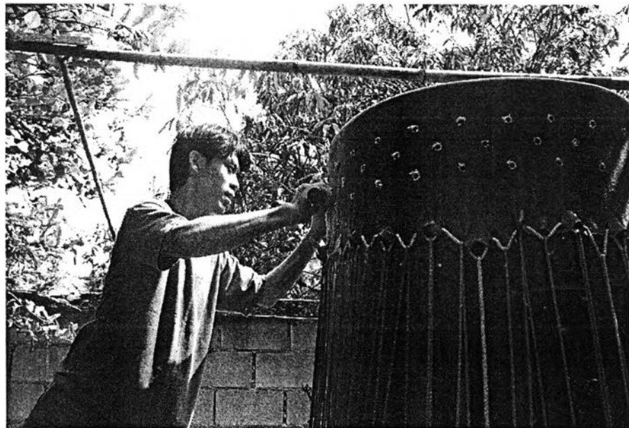
ภาพที่ 100 การใช้มีดตัดหนังแต่งรูสลัก
