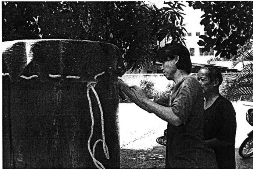
ภาพที่ 82 นำหนังมาหุ้มหน้ากลอง
