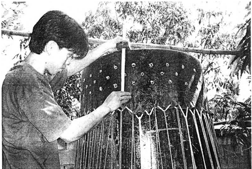
ภาพที่ 102 การใช้เหล็กชูด ทำเครื่องหมายขอบหนัง
