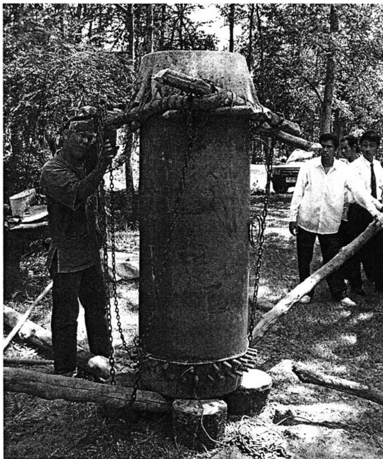
ภาพที่ 119 การหุ้มหนังแบบกะโด้รูปแบบของสล่ามิตร นันทะโย บ้านนาแกใต้ อ.งาว จ.ลำปาง ใช้โชแทนการใช้เชือกกรั้ง
