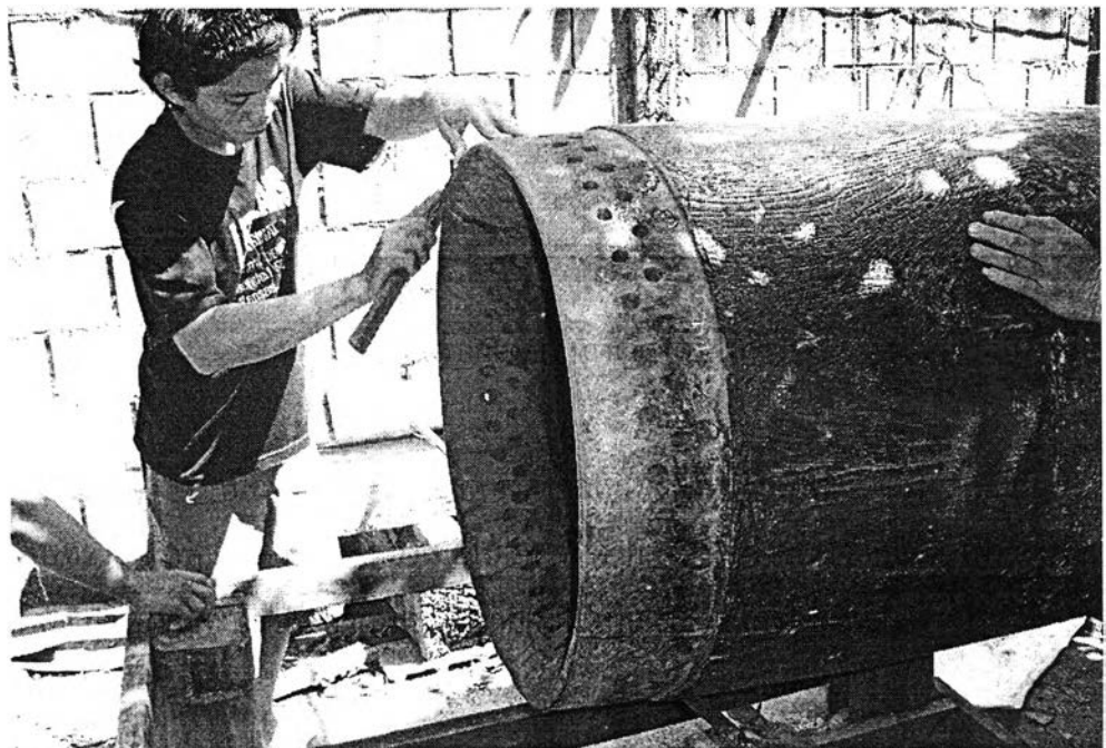
ภาพที่ 81 การใช้กระดาษทรายและใช้ขี้ผึ้งขัดปากกลอง
