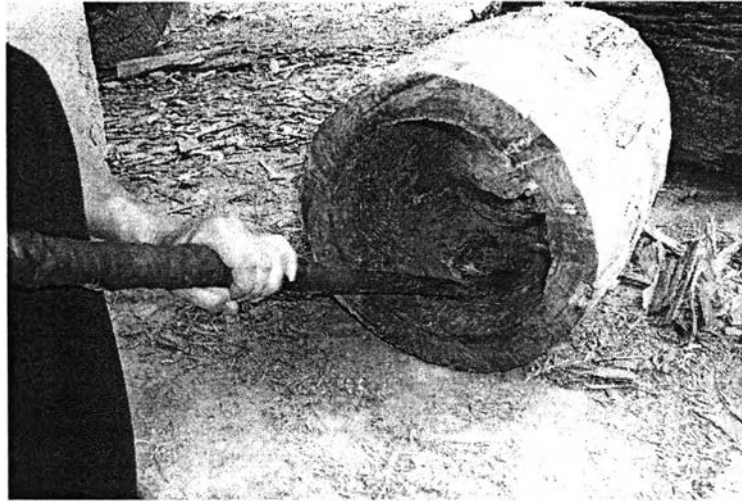
ภาพที่ 73 การใช้เหล็กชุด ตกแต่งบริเวณภายในตัวก่องลูกตุ้ม
