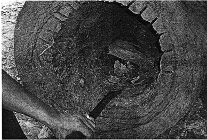
ภาพที่ 65 แสดงการกัดเอาเนื้อไม้ออกจากตัวกลอง
