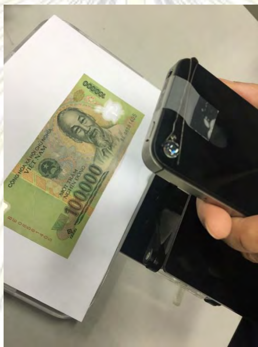
รูปที่ 3.8 การถ่ายภาพตัวอย่างด้วยเลนส์พอลิเอสเตอร์เรซิน
