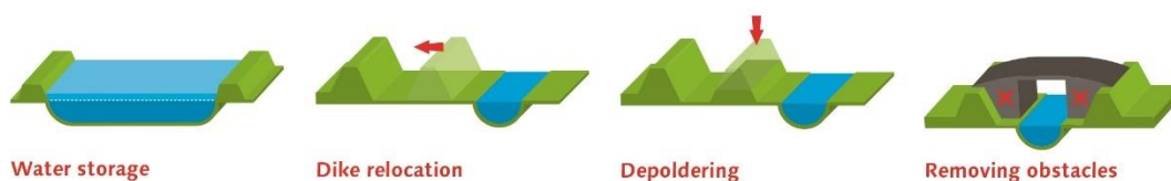
ภาพที่ 6-7 วิธีการออกแบบพื้นที่ตามแนวคิด Room for the River (ดัดแปลงจาก Ruimte voor de Rivier, 2016)
