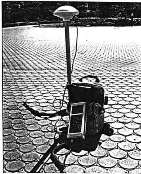
รูปที่ ก.1 ชุดอุปกรณ์เครื่องรับสัญญาณดาวเทียม GPS รุ่น Pro XL
