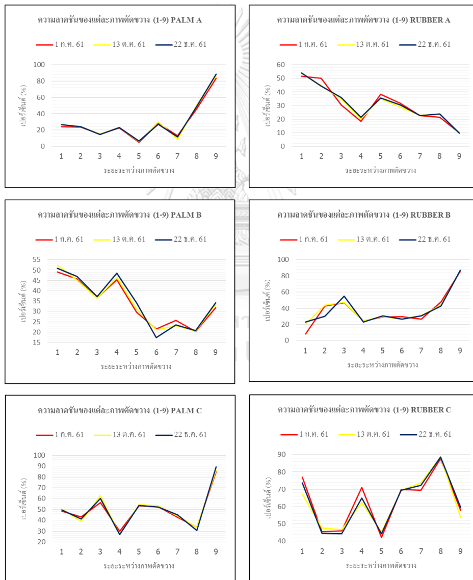
ภาพที่ 29 กราฟแสดงการเปลี่ยนแปลงความลาดชันของร่องธารในสวนปาล์มและสวนยางพารา ข้อมูลเมื่อวันที่ 1 ก.ค. 2561, 13 ต.ค. 2561 และ 22 ธ.ค. 2561
