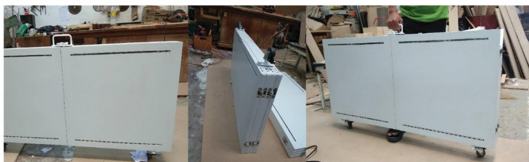
ภาพที่ 4.39 งานต้นแบบที่ถูกยึดรวมหน่วยด้วยตัวยึดมาตรฐานส่วน A และ B
