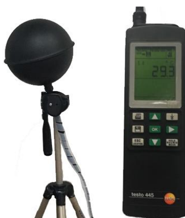
รูปที่ 3.2 โกลบเทอร์โมมิเตอร์และ Testo 445 ที่ใช้วัดอุณหภูมิการแผ่รังสีความร้อน
