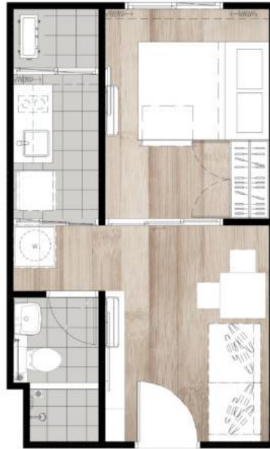
ภาพที่ 4.8 ผังห้องพักอาศัย 1 Bedroom Type A ขนาด 25.50 ตร.ม.
