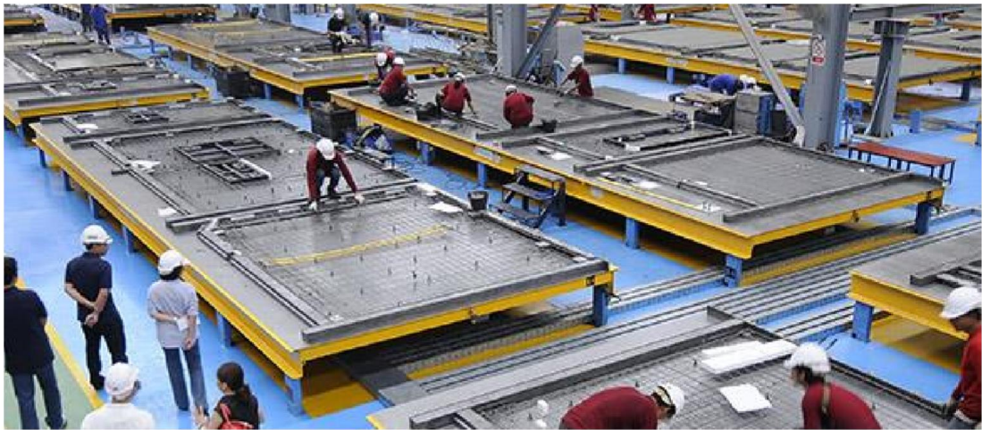
รูปที่ 70 ชั้นส่วนผนังคอนกรีตสำเร็จรูปที่ต้องการตัดตะแกรงเหล็กเสริม
