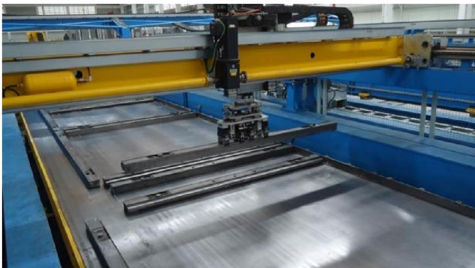
รูปที่ 67 การวางแบบข้างเหล็กบนโต๊ะแบบ
