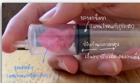
ภาพที่ 9 ตัวอย่างการออกแบบการตรวจสอบสมมติฐานของนักเรียนคนที่ 1 ในการศึกษาทฤษฎีของบอยล์
