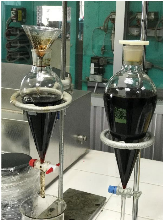
รูปที่ 43 ของเหลวที่ได้จากกระบวนการไพโรไลซิสในกรวยแยกสาร
