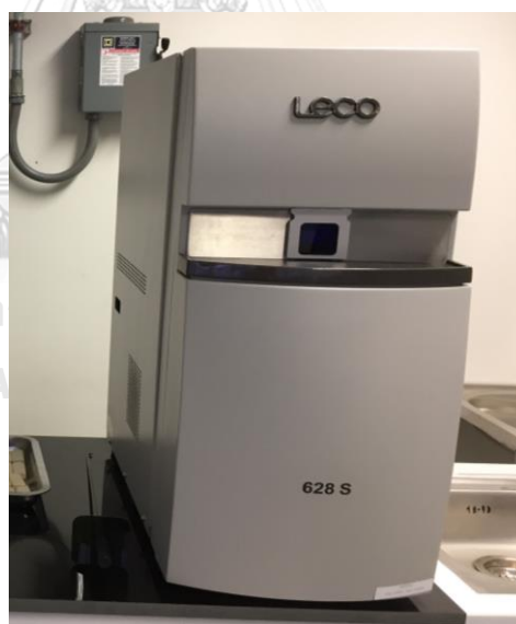
รูปที่ 39 เครื่องวิเคราะห์แบบแยกธาตุ ยี่ห้อ LECO รุ่น CHN 628S
