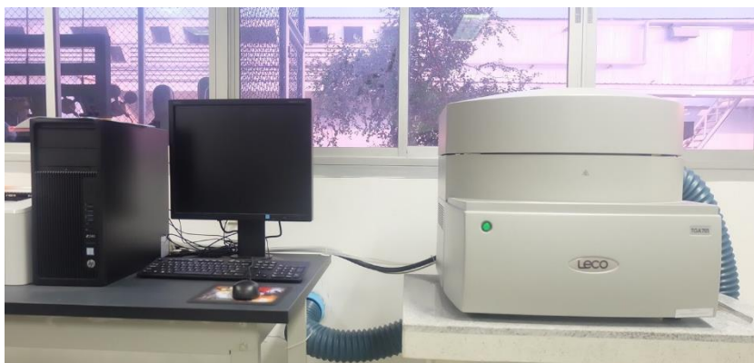
รูปที่ 41 เครื่อง Thermogravimetric analyzer ยี่ห้อ LECO รุ่น TGA701
