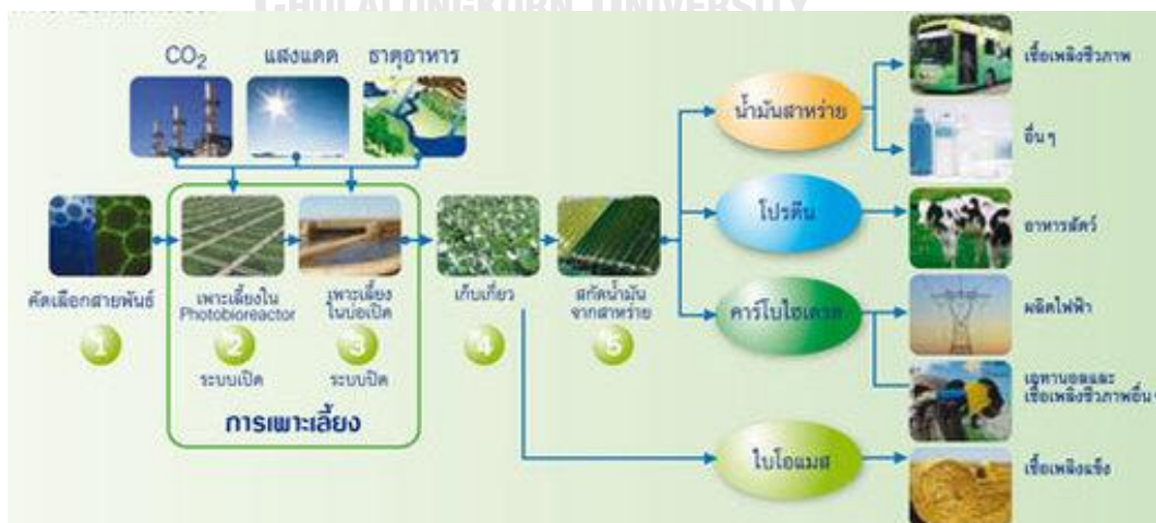
รูปที่ 10 ขั้นตอนการผลิตเชื้อเพลิงชีวภาพจากสาหร่ายขนาดเล็ก (ที่มา: กลุ่มพัฒนามาตรฐานน้ำมันเชื้อเพลิง สำนักคุณภาพน้ำมันเชื้อเพลิง, 2557)
