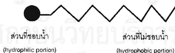
รูปที่ 2.1 แสดงลักษณะโครงสร้างโดยทั่วไปของสารลดแรงตึงผิวชีวภาพ ( Fiechter, 1992)
