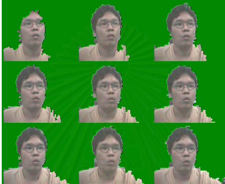
รูปที่ 4.32 ผลการแยกส่วนภาพโดยเทคนิคการตัดสีใจแบบเบย์ เฟรมที่ 1 ถึง 9
