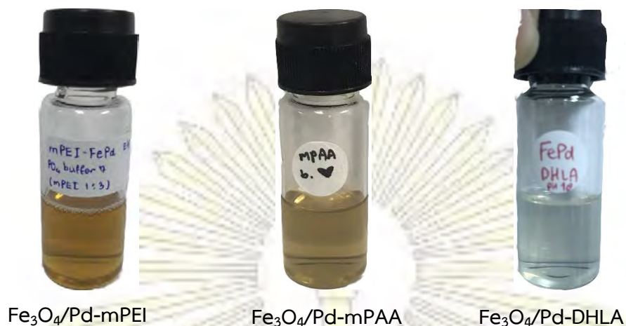
รูปที่ 3.11 อนุภาคนาโนของเหล็กออกไซด์-พัลลาเดียมที่เชื่อมต่อกับ stabilizer ชนิดต่าง ๆ กระจายตัวอยู่ในสารละลายบัฟเฟอร์
