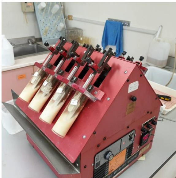
รูปที่ 13 แสดงการทดสอบด้วยการแปรงฟันด้วยเครื่อง V8 cross – brushing machine
