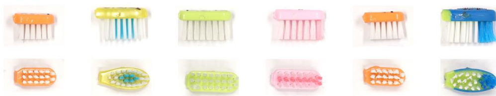
รูปที่ 14 แสดงขนแปรงหลังการทดสอบด้วยการแปรงฟันเรียงยี่ห้อจากซ้ายไปขวาคือ CUdent (7mm), Colgate®, Berman®, Kodomo®, CUdent (8mm) และ Fluocaril®
