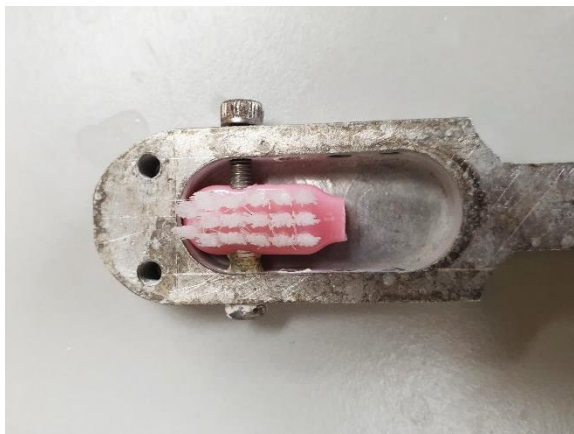
รูปที่ 10 แสดงหัวแปร่งที่ถูกยึดเข้ากับตัวจับหัวแปร่งที่สามารถใช้กับเครื่องแปร่งฟัน
