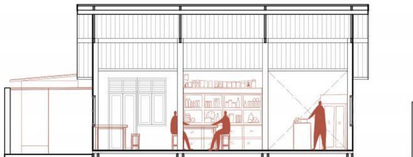
— สีดำ แสดงองค์ประกอบเดิม — สีแดง แสดงองค์ประกอบที่ต่อเติมใหม่ ภาพ 4-31 รูปตัดกรณีศึกษา D แสดงองค์ประกอบที่เกิดการเปลี่ยนแปลงภายหลังดำเนินการ ที่มา : ผู้วิจัย
