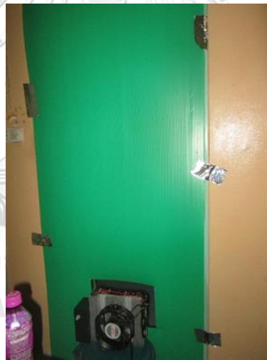
ภาพที่ 41 ตำแหน่งวางชุดอุปกรณ์เทอร์โมอิเล็กทริก สูงจากพื้น 35 เซนติเมตรของฝั่งติดกับประตูห้องน้ำ
