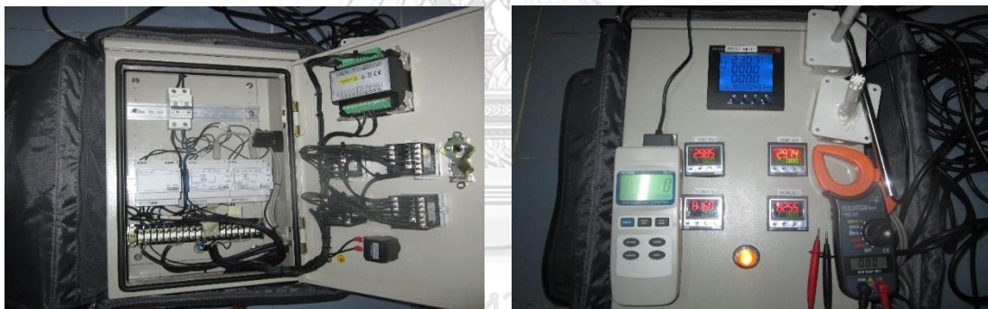
ภาพที่ 39 อุปกรณ์เครื่องมือวัดทำการวิจัย ประกอบไปด้วย ชุดวัดความชื้นสัมพัทธ์ 2 ตัว, วัดอุณหภูมิ 2 ตัว, เครื่องวัดความเร็วลม, เครื่องวัดแรงดันไฟฟ้า
