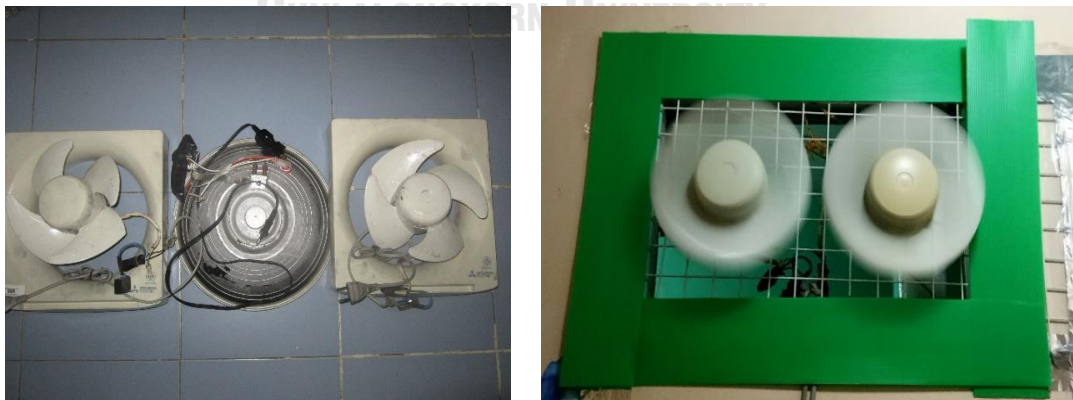
ภาพที่ 37 ชุดฮีตเตอร์ กับพัดลมระบายอากาศ
