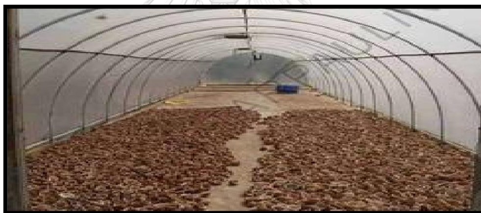
รูปที่ 2.6 การอบแห้งด้วยพลังงานแสงอาทิตย์
