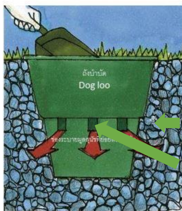
ภาพที่ 11 ตัวอย่างการฝังถังบำบัดมูลสุนัขและการระบายของเสีย ที่มา : ปรับปรุงจาก (สำนักพิมพ์บ้านและสวน, เข้าถึงเมื่อพฤศจิกายน 2563)
