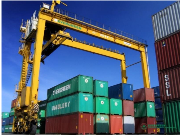
ภาพที่ 2.2 Transtainer หรือ Rubber Tire Gantry Crane (RTG) ที่มา: Evergreen Container Terminal (Thailand) (2020)
