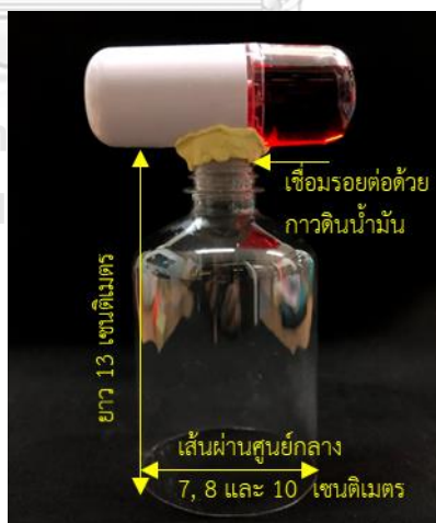
ภาพที่ 3.2 แสดงการประกอบปากกระบอกพ่นเข้ากับเครื่องพ่นละอองขนาดเล็ก
