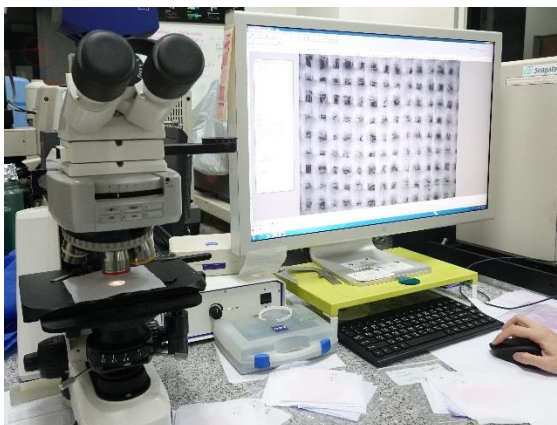
ภาพที่ 3.3 การศึกษาพื้นผิวหลังเคลือบด้วยสารละลายต้นแบบสีแดงด้วยกล้องจุลทรรศน์แบบใช้แสง
