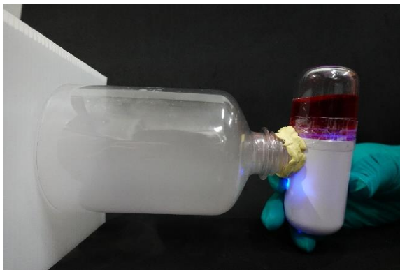
รูปที่ 3.3 การเคลือบด้วยเครื่อง Ultrasonic atomizer โดยวางผ้าในแนวตั้ง
