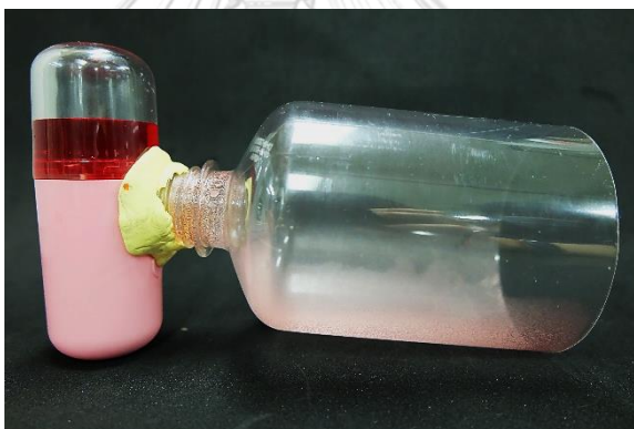
รูปที่ 4.1 ผลการพ่นละอองขนาดเล็กโดยวางผ้าในแนวตั้ง
