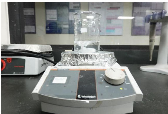
รูปที่ 3.5 การผสมสารละลายเพอร์เมทรีนเข้มข้น 0.5% w/v
