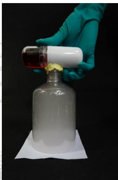
รูปที่ 3.4 การเคลือบด้วยเครื่อง Ultrasonic atomizer โดยวางผ้าในแนวนอน
