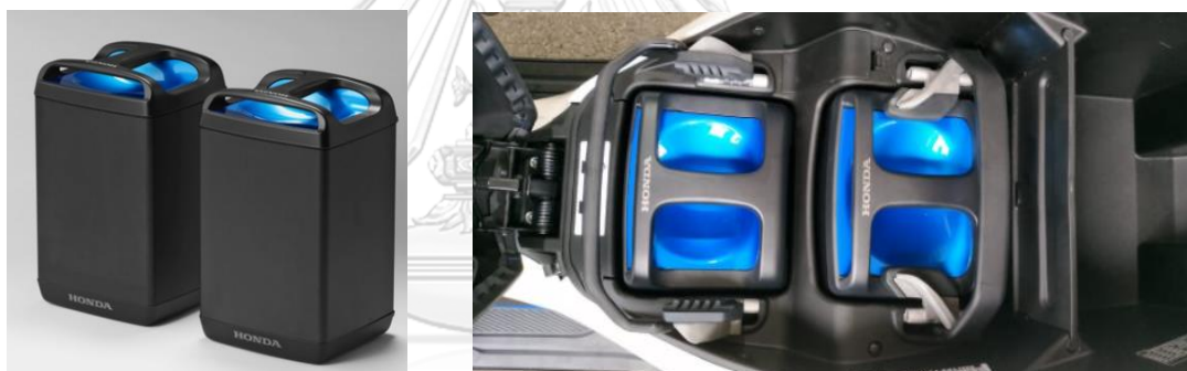
รูปที่ 9 ตัวอย่างแบตเตอรี่แบบ Hot Swapping Honda PCX EV ที่มารูป: https://images.app.goo.gl/xDYbjV22W3zuGm8s9
