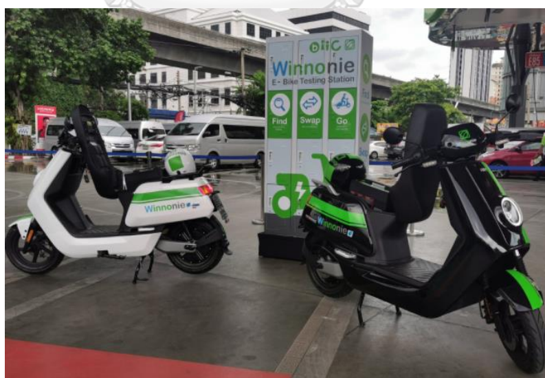
รูปที่ 13 ตัวอย่างตู้สับเปลี่ยนแบตเตอรี่รถจักรยานยนต์ไฟฟ้าแบบ Top plug swapping ของบางจาก โครงการวินโนนี่
