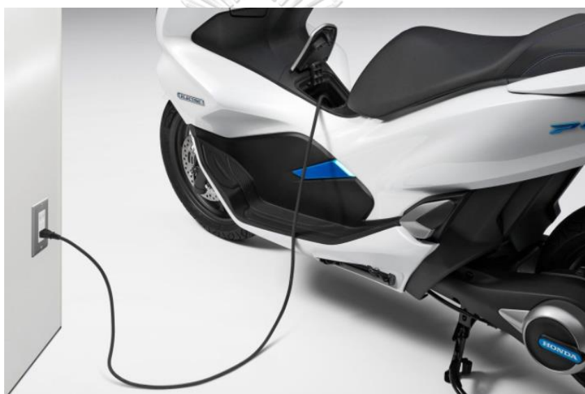
รูปที่ 31 ตัวอย่างอุปกรณ์เชื่อมต่อเพื่อชาร์จประจุแบบ On-Board Charging โดยใช้ไฟฟ้ากระแสสลับ
