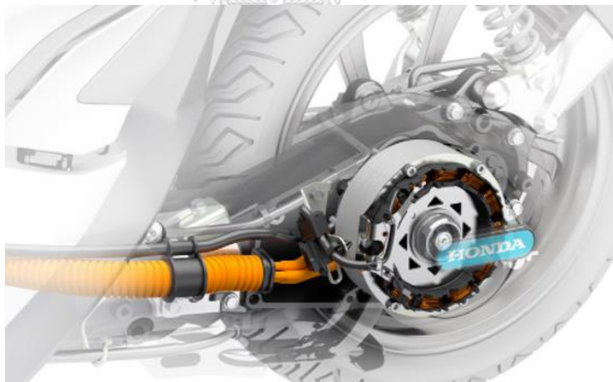
รูปที่ 6 ตัวอย่างโครงสร้างรถจักรยานยนต์ไฟฟ้าส่วนมอเตอร์ ที่มารูป : https://cleanscooter.in/honda-pcx-electric/
