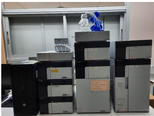
ภาพที่ 3.5 เครื่องโครมาโทกราฟีของเหลวสมรรถนะสูง (HPLC) ที่ใช้ในการวัดความเข้มข้นของยาแวนโคไมซินที่เวลาต่างๆ
