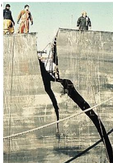
รูปที่ 2.2 แสดงรอยแตกหักของเรือส่งสินค้าในช่วงยุคสงครามโลกครั้งที่ 2 [12]
