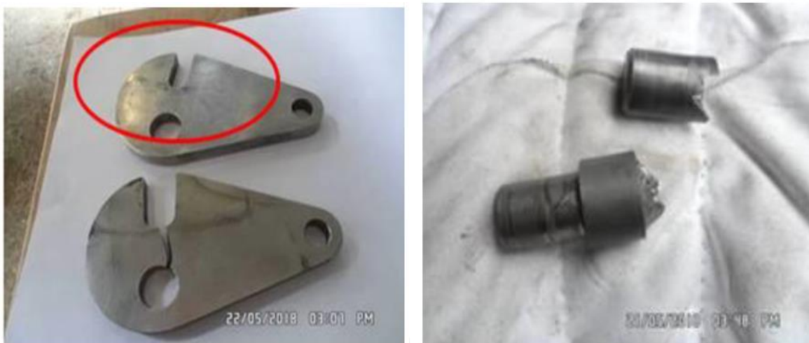
รูปที่ 1.3 ลักษณะความเสียหายของ (ก) สลักและ (ข) สลักพิน [2]
