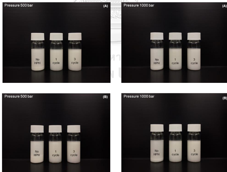
รูปที่ 31 อนุภาคลิโปโซมที่มีการเติมคลอเรสเตอรอลที่เตรียมได้หลังจากผ่านไป 3 วัน ที่ความเข้มข้นโดยรวมของลิพิด (A) ร้อยละ 2 (B) ร้อยละ 5 โดยน้ำหนัก
