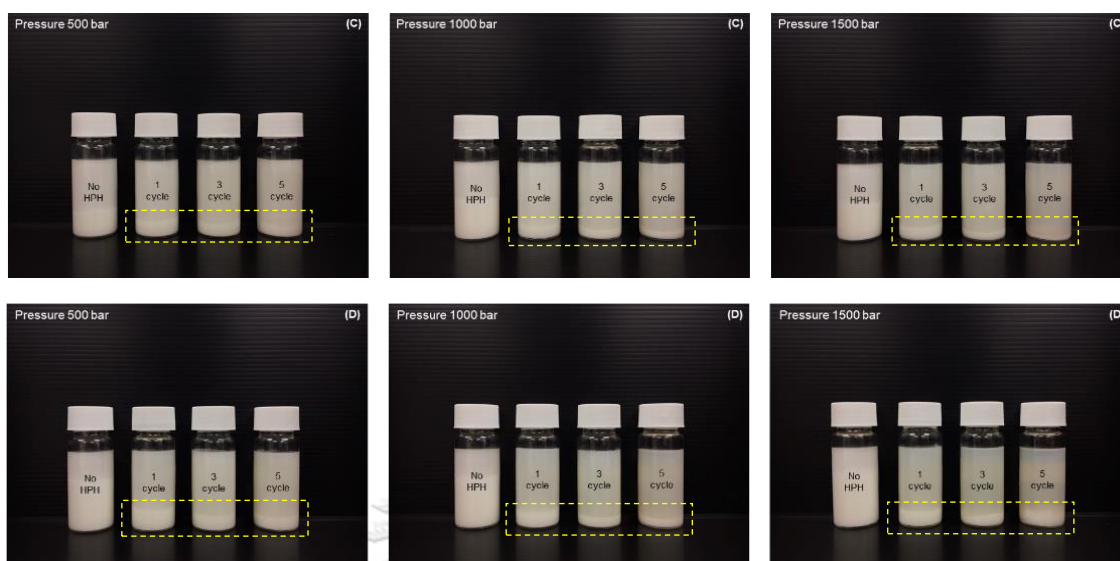
รูปที่ 26 อนุภาคลิโปโซมที่เตรียมได้หลังจากผ่านไป 3 วันที่ความเข้มข้นโดยรวมของลิพิด (A) ร้อยละ2 (B) ร้อยละ5 (C) ร้อยละ8 และ (D) ร้อยละ11 โดยน้ำหนัก
