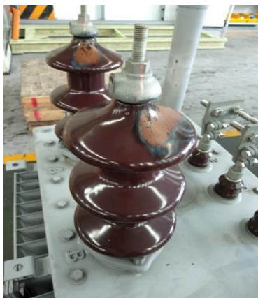
รูปที่ 12 การเกิดรอยวาบไฟที่บุชชิงแรงสูง
