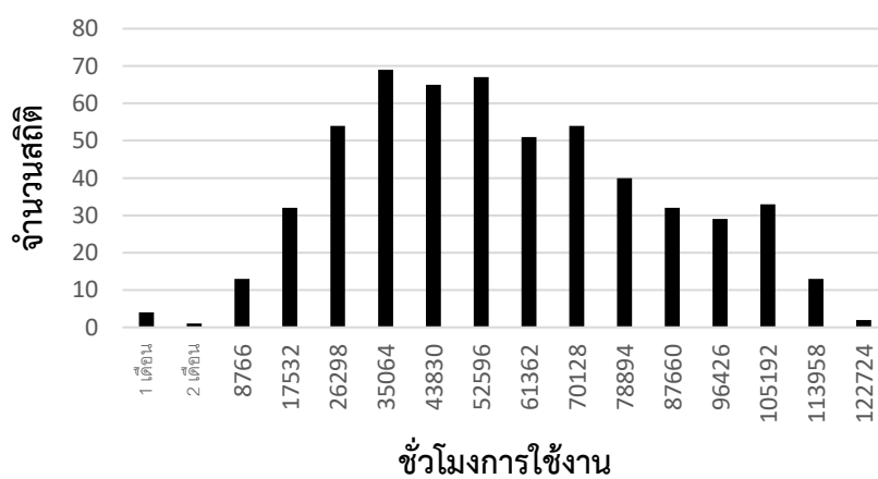
รูปที่ 41 กราฟจำนวนสถิติการบำรุงรักษาปะเก็นด้านแรงสูงและแรงต่ำ
