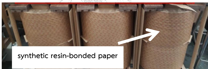
รูปที่ 7 กระดาษฉนวนแบบ synthetic resin bonded paper
