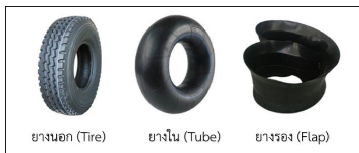
รูปที่ 1.2 ส่วนประกอบของยางแบบใช้ยางใน (Tube type)
