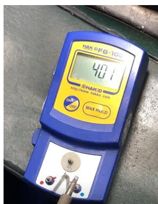
รูปที่ 3-7 การสอบเทียบอุณหภูมิหัวแร้งของเครื่องจักร
