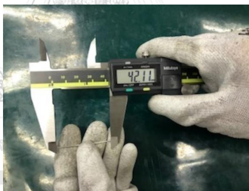
รูปที่ 3-8 การสอบเทียบความยาวของลวดตะกั่ว
