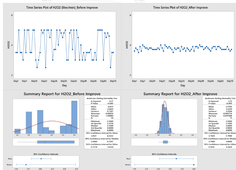
รูปที่ 61 กราฟข้อมูลปัจจัยนำเข้าของปริมาณสารเคมีไฮโดรเจนเปอร์ออกไซด์ (H 2 O 2 ) หน่วย liter/min ก่อนปรับปรุง และหลังปรับปรุงกระบวนการ
