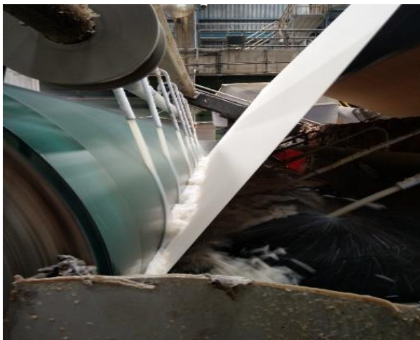
รูปที่ 3 การฉาบผิวหน้ากระดาษด้วยแป้งมันสำปะหลังที่ต้มสุกแล้วบนเครื่องจักร
