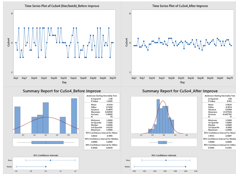
รูปที่ 62 กราฟข้อมูลปัจจัยนำเข้าของปริมาณสารละลายคอปเปอร์ซัลเฟต (CuSO 4 ) หน่วย liter/batch ก่อนปรับปรุง และหลังปรับปรุงกระบวนการ
