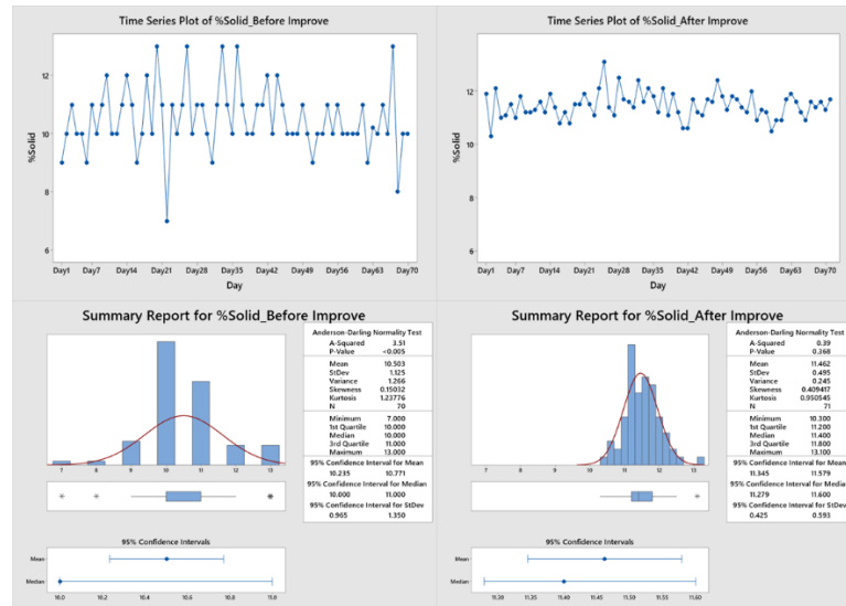
รูปที่ 60 กราฟข้อมูลปัจจัยนำเข้าของปริมาณความเข้มข้นของน้ำแป้ง (% Solid Content) ก่อนปรับปรุง และหลังปรับปรุงกระบวนการ
