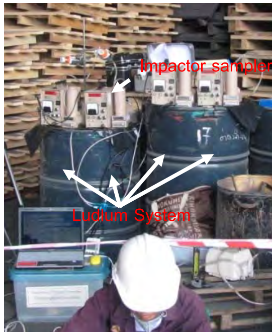
รูปที่ 5.3 แสดงระบบเก็บตัวอย่างและระบบการตรวจวัดการกระจายตัวของธาตุลูกหลานเรดอนและโธรอน
