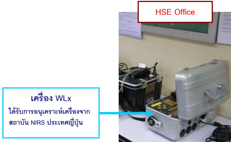
รูป 6.6 การตรวจวัดความเข้มข้นของเรดอนและโทรอน โดยวัดทางอ้อมจากความเข้มข้นของธาตุ ด้วยเครื่องวัดเครื่อง WLx ณ บริเวณโรงซักตัวอย่างแร่
