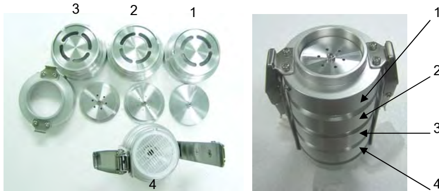
รูปที่ 2.5 อุปกรณ์เก็บตัวอย่างฝุ่นละออง (Impactor sampler)
