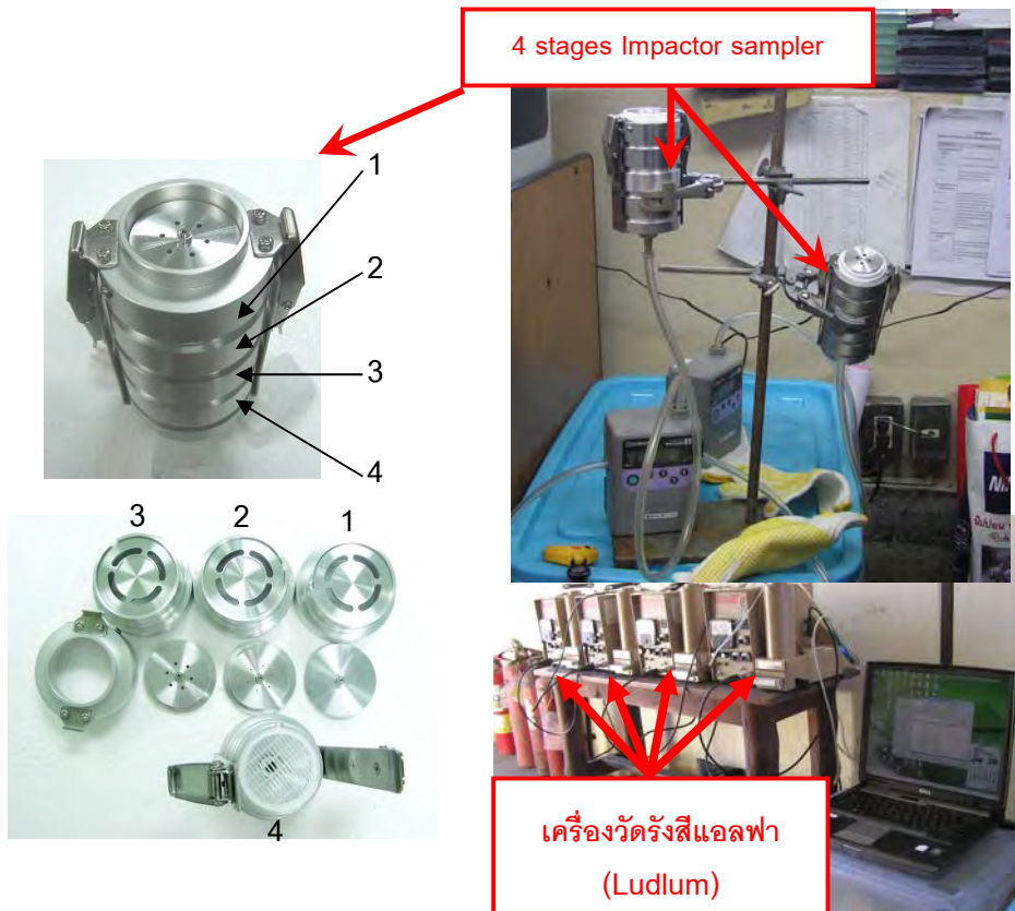
รูปที่ 6.5 แสดงระบบเก็บตัวอย่างและระบบการตรวจวัดการกระจายตัวของธาดูกลูกหลานเรดอนและโพรตอน
