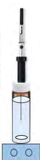
รูป 2.2 การสกัดด้วยเทคนิคการสกัดแบบ DI-SPME
