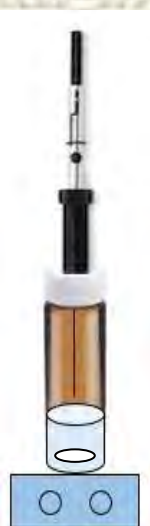
รูป 2.3 การสกัดด้วยเทคนิคการสกัดแบบ HS-SPME
