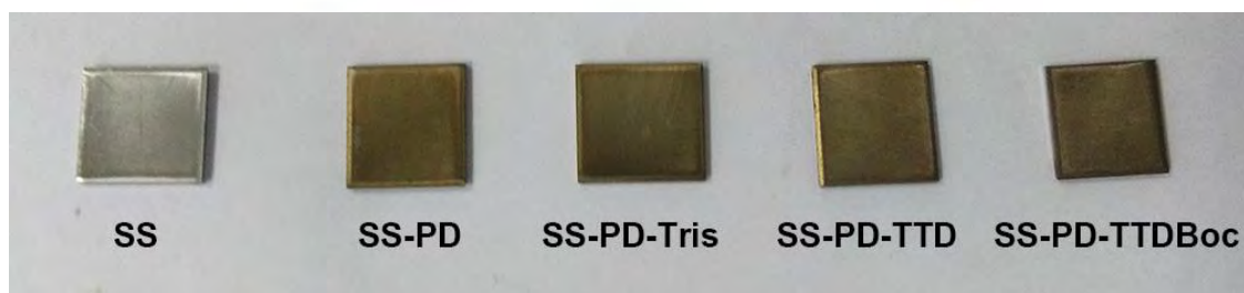
รูปที่ 3.13 แผ่นเหล็กกล้าไร้สนิม SS, SS-PD, SS-PD-TTD และ SS-PD-TTDBoc ตามลำดับ
