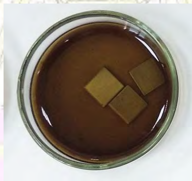
รูปที่ 3.12 แผ่นเหล็กกล้าไร้สนิมในสารละลายโดพามีนในบัฟเฟอร์ Tris 0.1 M pH 8.5 ที่เวลา 24 ชั่วโมง
