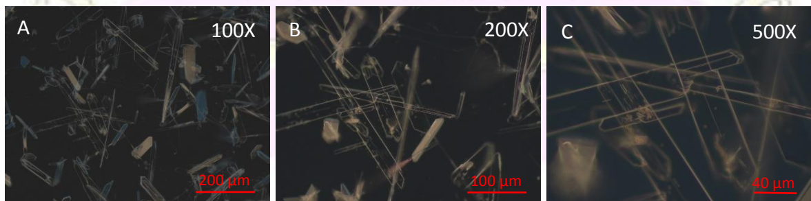
รูปที่ 3.11 ภาพจากกล้องจุลทรรศน์แบบใช้แสงของผลึกซิลเวอร์อะซิเตทที่สังเคราะห์โดยใช้น้ำเป็นตัวทำละลาย A: กำลังขยาย 100X B: กำลังขยาย 200X และ C: กำลังขยาย 500X
