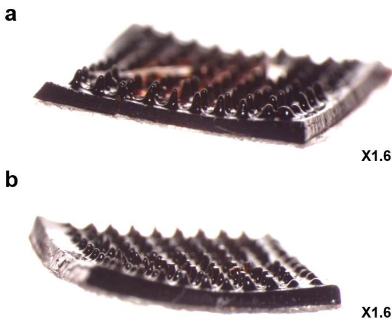
รูปที่ 3.21 ภาพถ่ายจากกล้องจุลทรรศน์ดิจิทัลแบบใช้แสงแสดงลักษณะแผ่นไมโครนิตเดิ้ลหลังปักบนผิวหนังหมู a) ไมโครนิตเดิ้ลที่มีน้ำตาลมอลโทส b) ไมโครนิตเดิ้ลที่ไม่มีน้ำตาลมอลโทส
