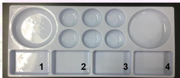
รูปที่ 2.5 งานสีพลาสติกที่ใช้ขึ้นรูปแผ่นพอลิเมอร์
