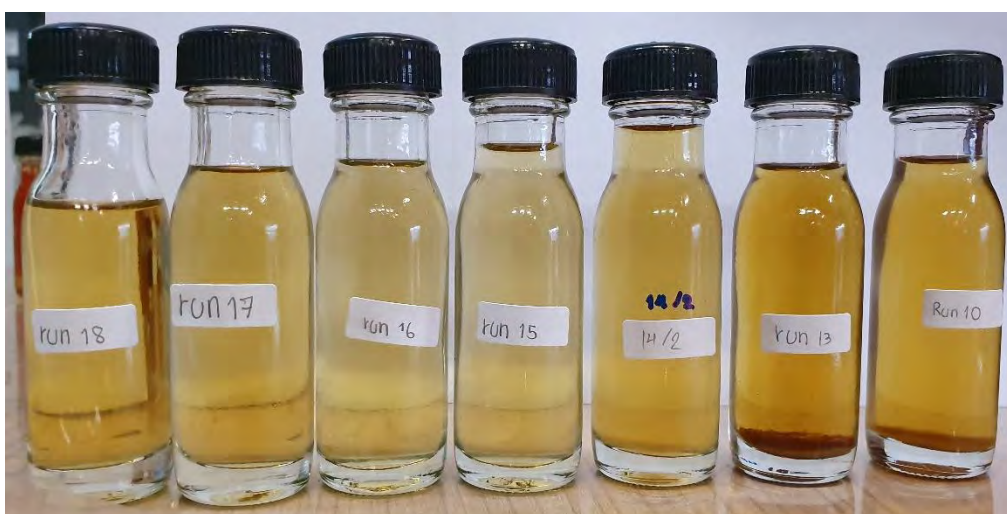
รูปที่ 4.1 สีของผลิตภัณฑ์กลีเซอรินหลังฟอกสีที่ใช้ปริมาณแอกทิเวเทดเคลย์ในการทำปฏิกิริยาต่างกัน
