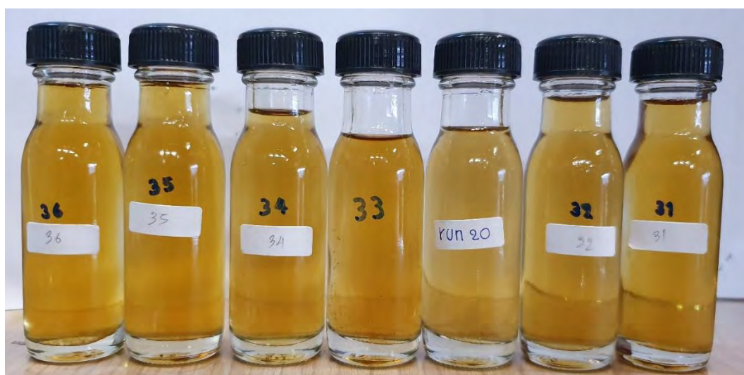
รูปที่ 4.4 สีของผลิตภัณฑ์กลีเซอรินหลังฟอกสีที่ทำปฏิกิริยาในสภาวะความเป็นกรด/เบสที่ต่างกัน
