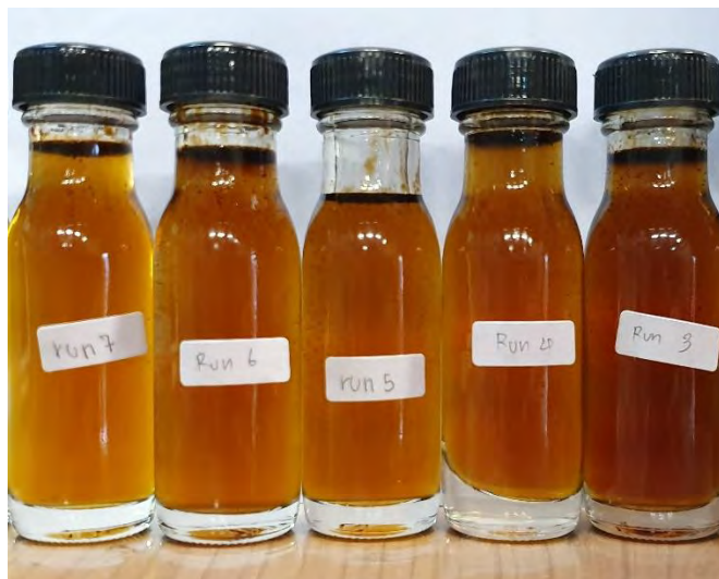
รูปที่ 4.2 สีของผลิตภัณฑ์กลีเซอร์ีนหลังฟอกสีที่ใช้อุณหภูมิขณะทำปฏิกิริยาต่างกัน โดย ก. เป็นการฟอกที่อุณหภูมิต่ำกว่า 60 องศาเซลเซียส (ซ้ายมือ) และ ข. เป็นการฟอกที่อุณหภูมิสูงกว่า 60 องศาเซลเซียส (ขวามือ)
