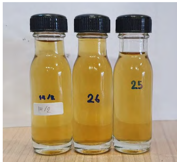
รูปที่ 4.2 สีของผลิตภัณฑ์กลีเซอร์ีนหลังฟอกสีที่ใช้อุณหภูมิขณะทำปฏิกิริยาต่างกัน โดย ก. เป็นการฟอกที่อุณหภูมิต่ำกว่า 60 องศาเซลเซียส (ซ้ายมือ) และ ข. เป็นการฟอกที่อุณหภูมิสูงกว่า 60 องศาเซลเซียส (ขวามือ)
