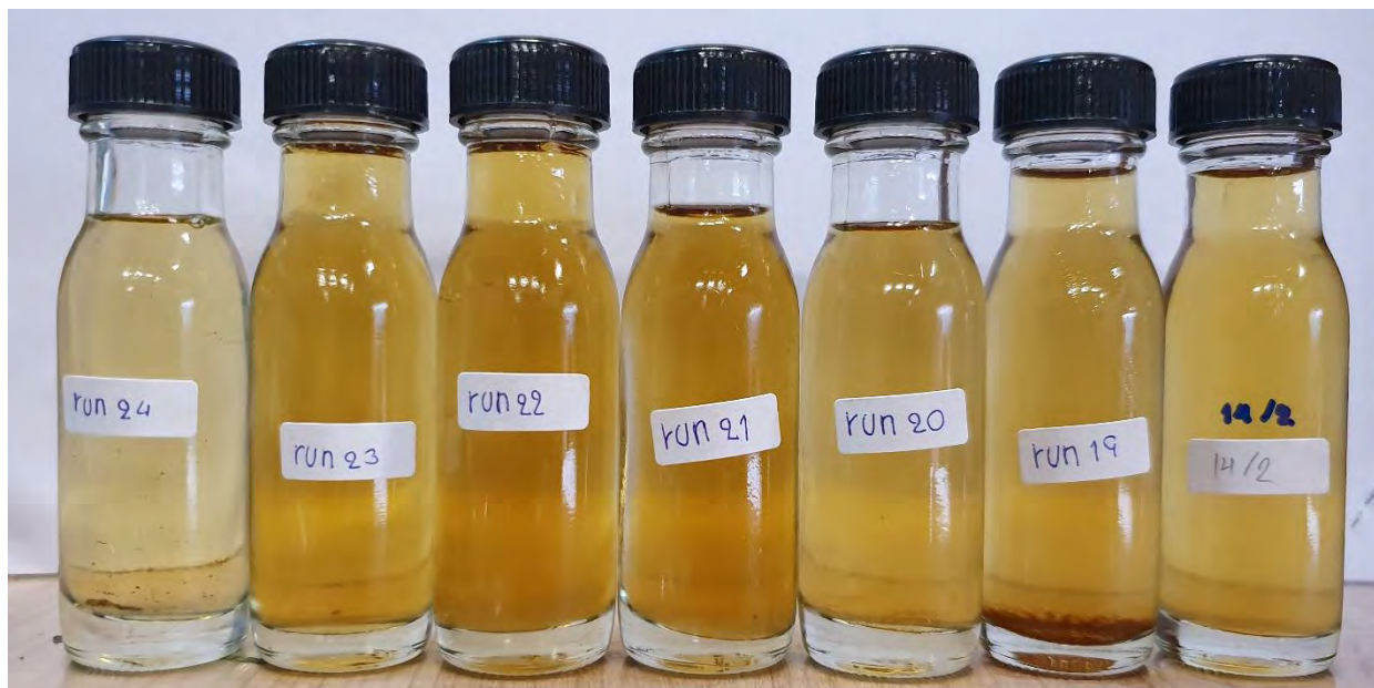
รูปที่ 4.3 สีของผลิตภัณฑ์กลีเซอรินหลังฟอกสีที่ใช้เวลาในการทำปฏิกิริยาที่ต่างกัน
