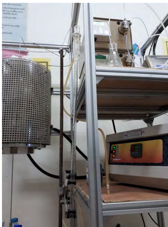
รูปที่ 3.1 ชุดเครื่องปฏิกรณ์แบบเบตนิ่งสำหรับงานวิจัย
