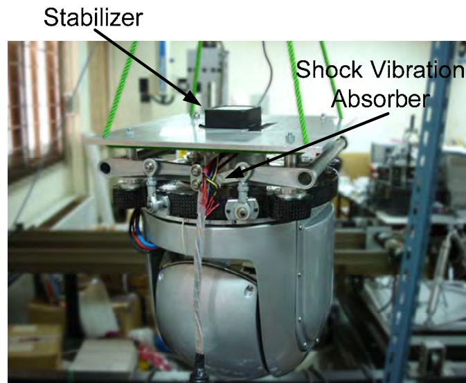
รูปที่ 6.2 การติดตั้งเครื่องมือวัดการหมุนรอบที่ส่วนฐานของโครงสร้างกิมเบล
