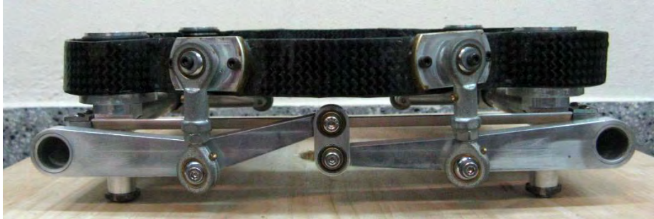
(ก) มุมมองด้านหน้าของโครงสร้างลดการสั่นสะเทือน
