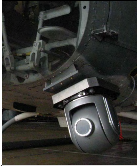
รูปที่ 6.21 การติดตั้งอุปกรณ์การถ่ายภาพบนเฮลิคอปเตอร์ในการทดสอบภาคสนาม
