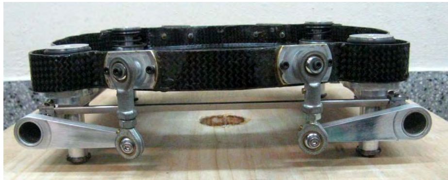
(ข) มุมมองด้านหลังของโครงสร้างลดการสั่นสะเทือน
