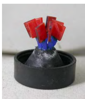
ภาพที่ 5 แสดงการยึดแบบหล่อดูราเลย์กับซีพิ้งแกนค้ำรูเท (sprue wax)
