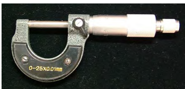
ภาพที่ 7 แสดงเครื่องวัดความหนาไมโครมิเตอร์
