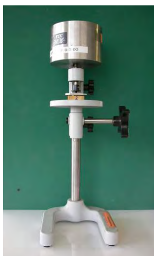
ภาพที่ 17 แสดงการยืดชิ้นงานด้วยเครื่องทดสอบความแข็งแรงวัสดุที่มีค้ำน้ำหนัก 5 กิโลกรัม
