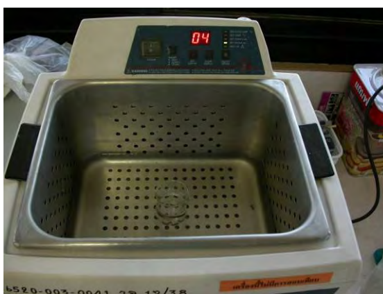
ภาพที่ 13 แสดงการทำความสะดวกขึ้นงานด้วยเครื่องทำความสะดวกความถี่เหนือเสียง
