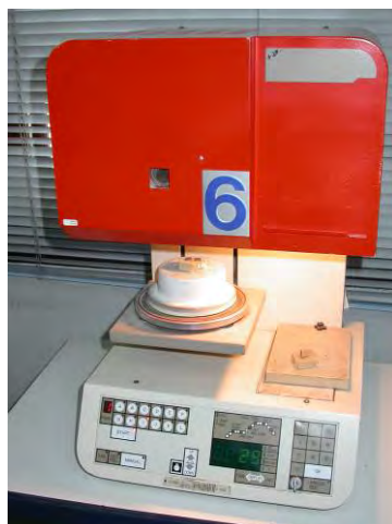
ภาพที่ 10 แสดงเตาเผาโครงโลหะเพื่อสร้างชั้นออกไซด์
