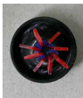
ภาพที่ 5 แสดงการยึดแบบหล่อดูราเลย์กับซีพิ้งแกนค้ำรูเท (sprue wax)
