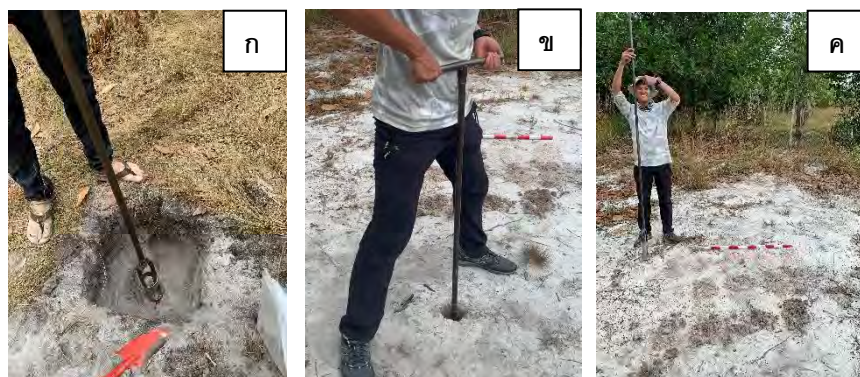
รูปที่ 3.4 การเก็บตัวอย่างโดยใช้ Hand auger สำหรับตะกอนร่วนหรือตะกอนทราย
