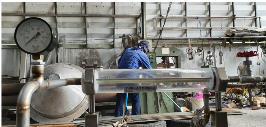
ภาพที่ 7: ห้องกรองที่สามารถใช้ได้ทั้งการกรองแบบรีเวิร์สออสโมซิสและอัลตราฟิลเตรชัน
