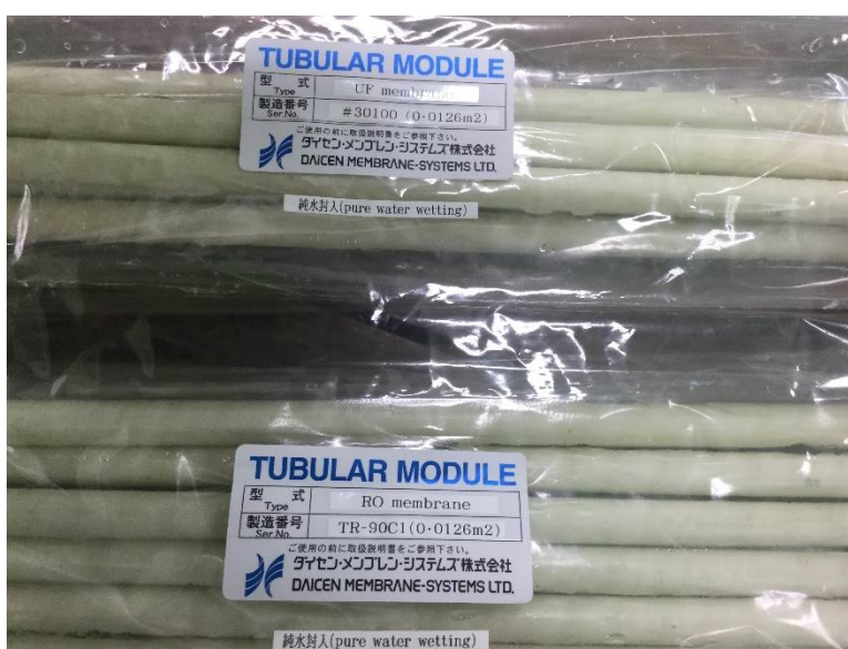
ภาพที่ 8: เมมเบรนชนิดท่อกลวงสำหรับการกรองแบบอัลตราฟิลเตรชัน (ด้านบน) และรีเวิร์สออสโมซิส (ด้านล่าง)
