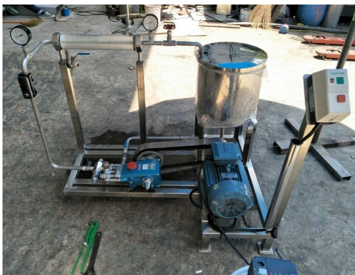
ภาพที่ 6: เครื่องกรองที่สามารถใช้ได้ทั้งการกรองแบบรีเวิร์สออสโมซิสและอัลตราฟิลเตรชัน
