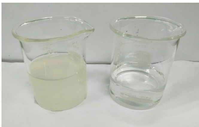
ภาพที่ 9: น้ำมะพร้าวก่อน (ด้านซ้าย) และหลังผ่านกระบวนการกรองแบบไมโครฟิลเตรชัน (ด้านขวา)
