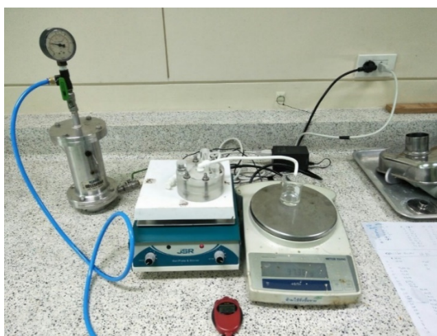
ภาพที่ 3: เครื่องมือการกรองแบบไมโครฟิลเตรชัน
